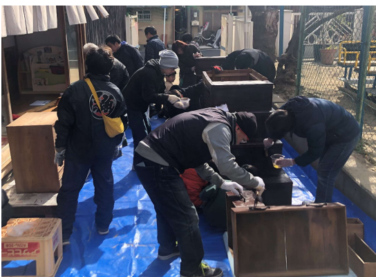
箱階段と小箆箆に油を引き仕上げっていきます
